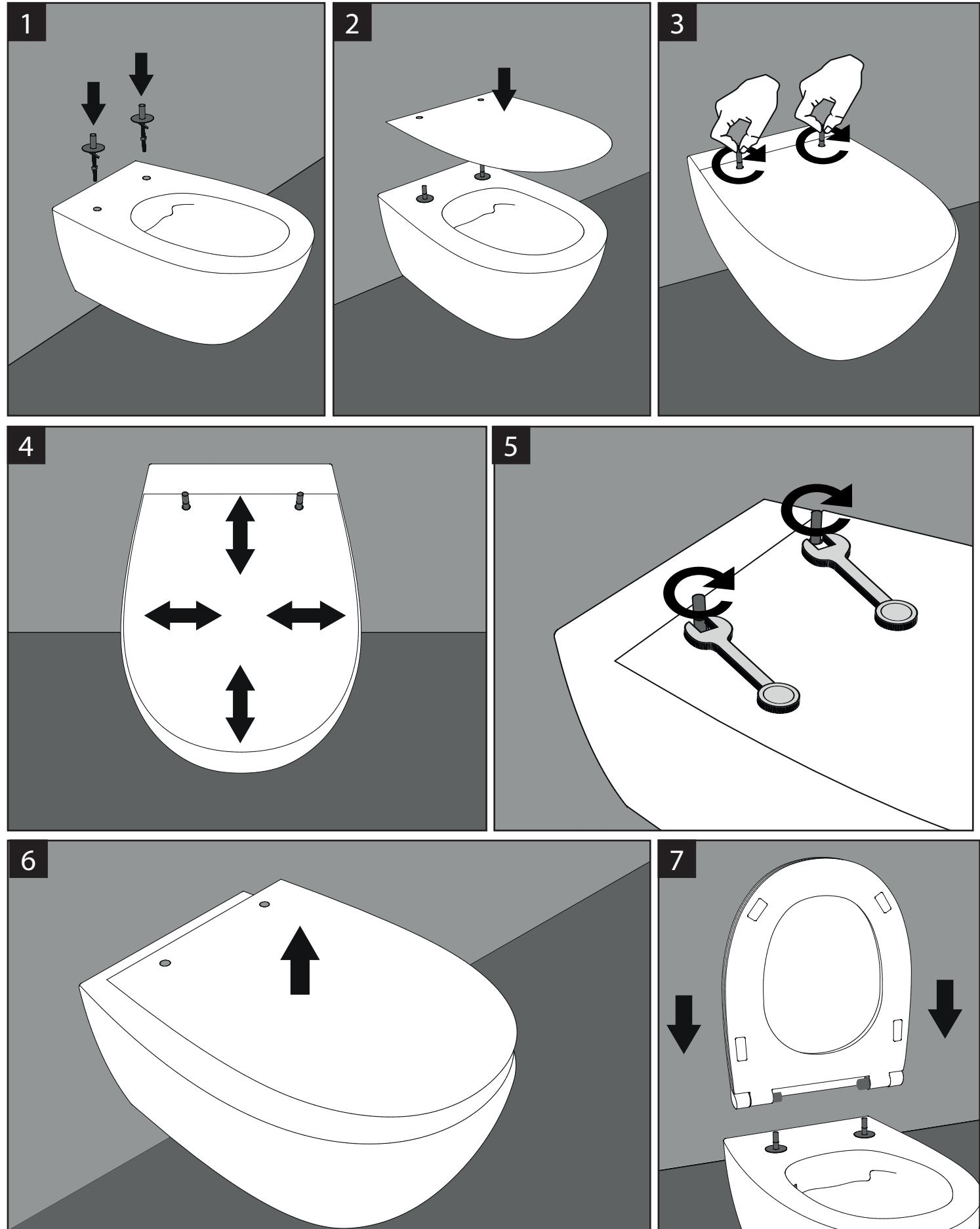
ISTRUZIONI DI MONTAGGIO E REGOLAZIONE CERNIERE
